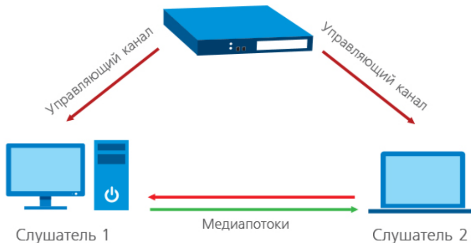
Рис.1 – Схема видеосвязи 1-на-1 [4]
